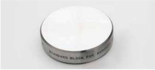
硬さ標準片 Hardness standard block
